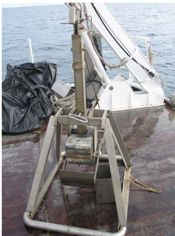
Figura 3.5.2.a - Box-corer utilizzato per il prelievo del sedimento per lo studio delle caratteristiche chimiche (Monitoraggio ISPRA, Dicembre 2008)
