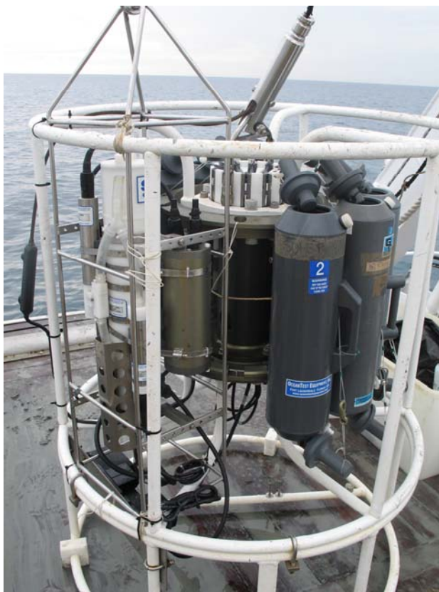
Figura 35.1.a – Rosette con bottiglie Niskin e sonda CTD SBE 19 (Monitoraggio ISPRA, Dicembre 2008)
