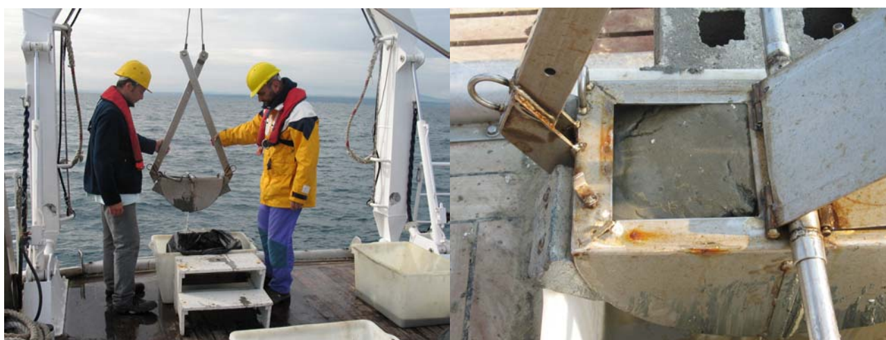
Figura 3.6.2.a - Benna Van Veen utilizzata per il prelievo di sedimento per lo studio delle comunità macrobentoniche (Monitoraggio ISPRA, Dicembre 2008)
