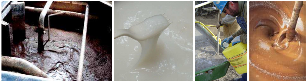
FIG. 18: Esempi di fanghi e fluidi perforanti usati per le operazioni di scavo e di formazione dei pozzi petroliferi
