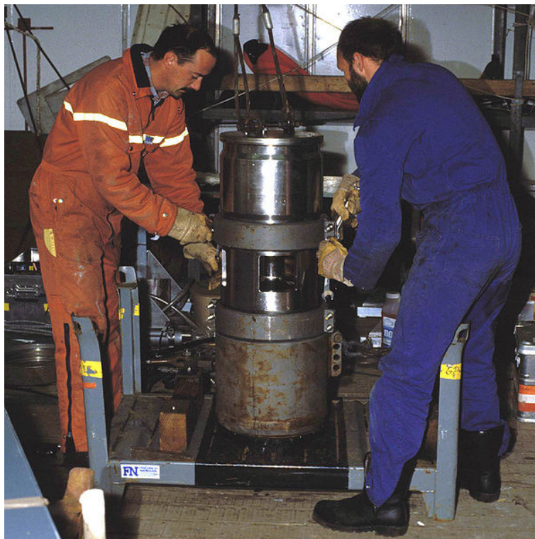
Figura 2.9 – Preparazione di un air gun
